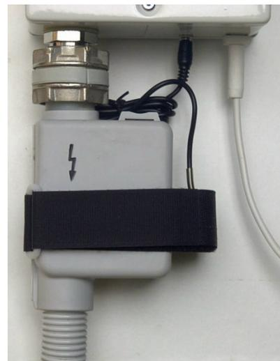
Dieses Gerät hat zusätzlich einen Magnet-Sensor, der das Öffnen des Waschmaschinen-Magnetventils\*) erkennt und beim ersten Einspülen das ALFA MIX startet.
