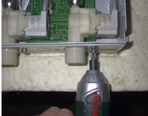
Ventil-Befestigungsschrauben am Gehäuse lösen
