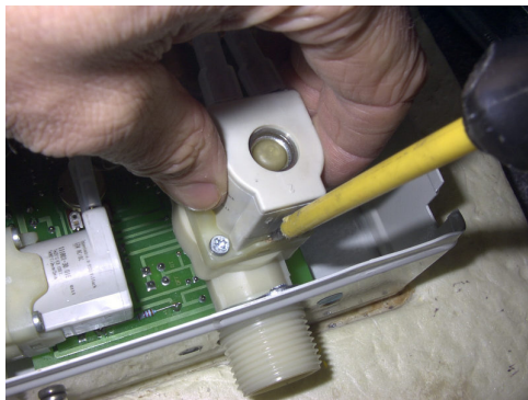
Mit einem spitzen Schraubenzieher Halteklappe der Ventilschule vorsichtig etwas abreißen und Spule abziehen (u.U. etwas schwergängig)
